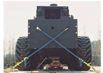
Vertikalwinkel  $\alpha$  (Winkel zwischen Zurrmittel und Ladefläche) von ca. 20° bis 55° und Horizontalwinkel  $\beta$  (Winkel zwischen Zurrmittel und Bordwand) sollte zwischen 10° und 45° liegen.
